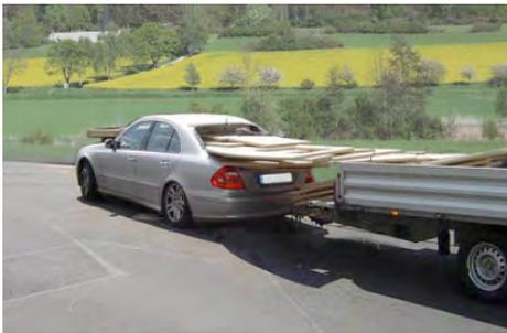
Bild links: Die auf einem Anhänger (mit Stahlbändern und zwei Gurten) gesicherten Spanplatten kamen bei einem Ausweichmanöver ins Rutschen. Die Platten stießen über die Ladeklappe durch die Heckscheibe bis zur Frontscheibe.
